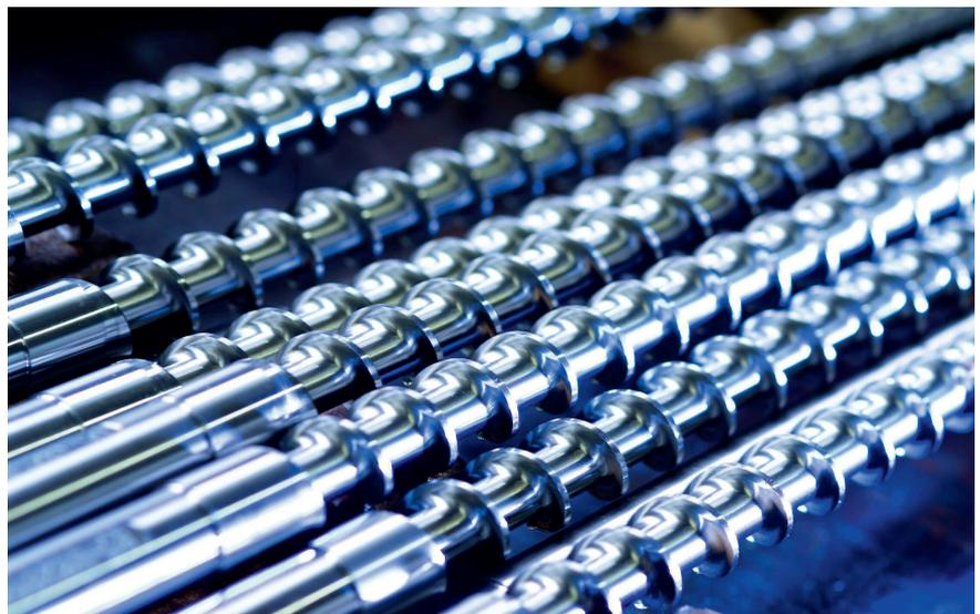
In mehreren Rechenschritten wird die Schneckengeometrie feinoptimiert, bis das gewünschte Ergebnis erzielt wird. In der Folge werden Versuchsschnecken in Originalgröße gefertigt und im praktischen Versuch mit diversen Materialtypen getestet (© Wittmann Battenfeld)
